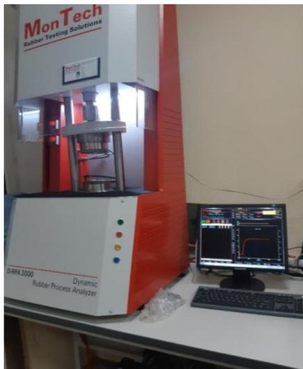
**Рис. 8.** Реометр MonTech MDR 3000 BASIC
