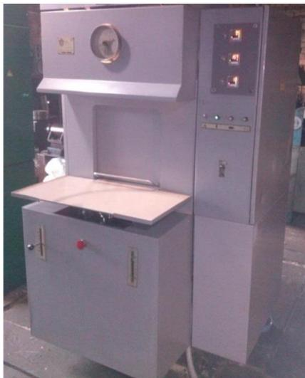
**Рис. 5.** Гидравлический вулканизационный пресс с индукционным нагревом 100-400-2Э
