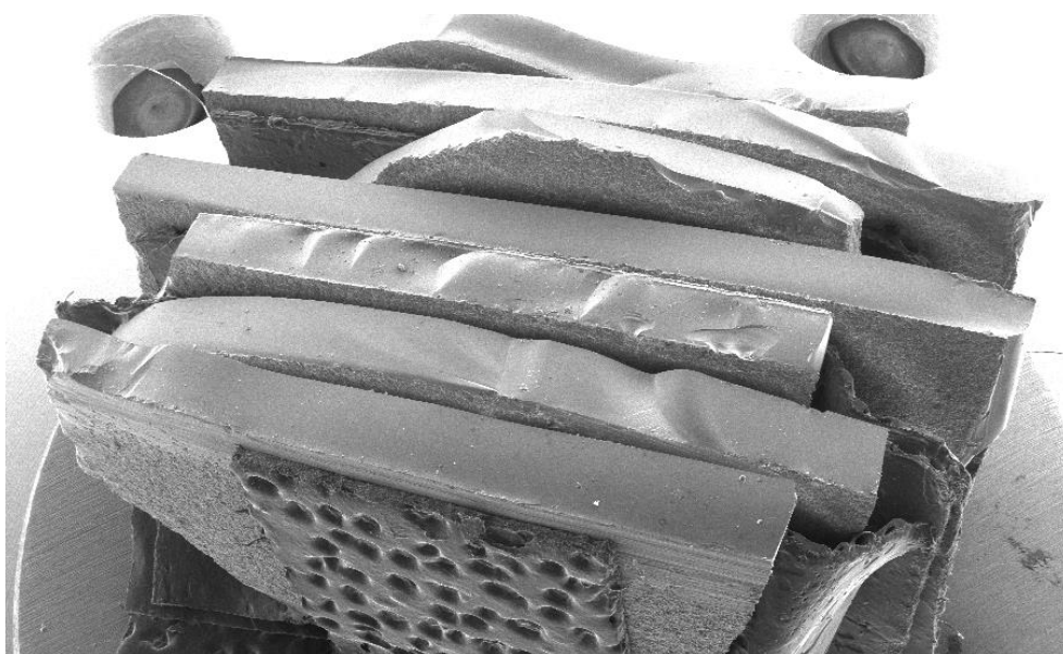
Рис. 2. Снимок «сендвича» из плёнок, напылённых на ситалле
